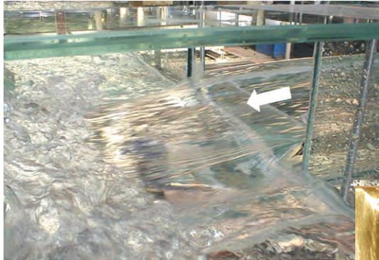
Visualisation du développement d'un jet torrentiel d'eau dans une zone ouverte.
